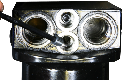
Afbeelding9. Afpluggen van de stuurleiding, optie 2.
